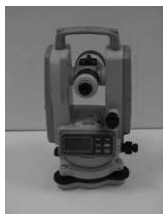
Taquímetre Leica , (lectura angles, digital, plomada òptica) preu 5 € dia
